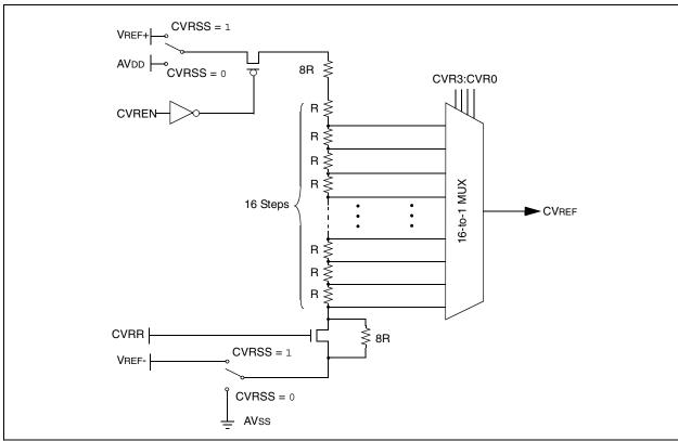
FIGURE 23-1: VOLTAGE REFERENCE BLOCK DIAGRAM
