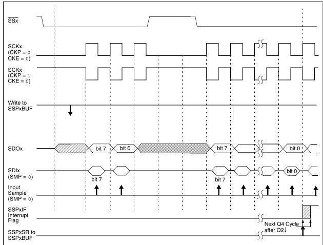
FIGURE 19-5: SPI™ MODE WAVEFORM (SLAVE MODE WITH CKE = 0)
